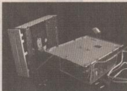
Крепление CD-привода к блоку питания
